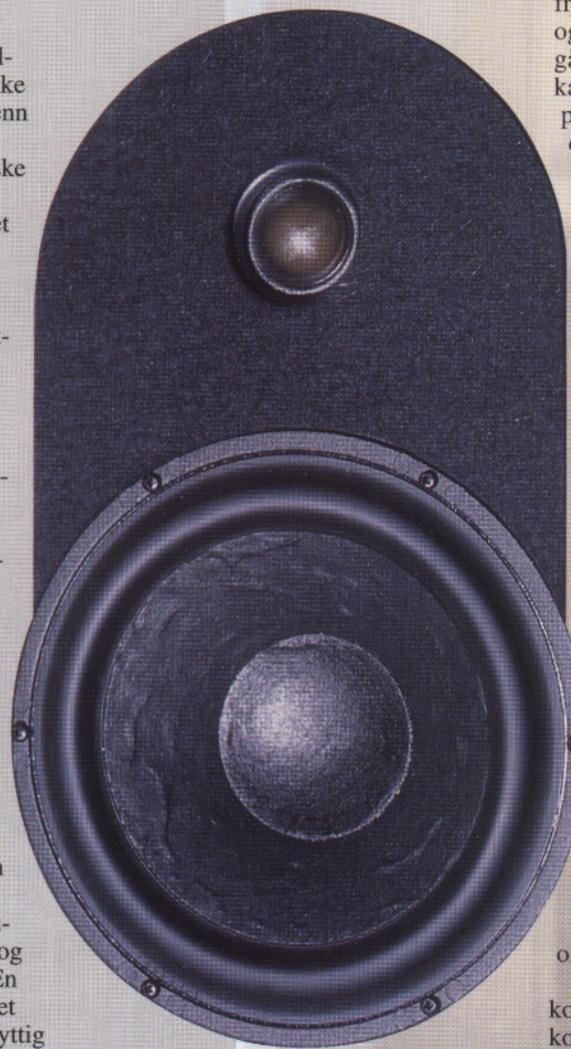
nok bare i en mellomgrå farge som bare en drabantby-arkitekt vil elske, men den 27 liter store kassen er solid bygget av hardpressede sponplater med akustisk lim mellom. Dette gir 4-5 ganger bedre damping enn for eksempel betong! Høyttalerelementene er noe av det beste som leveres på verdensmarka-
